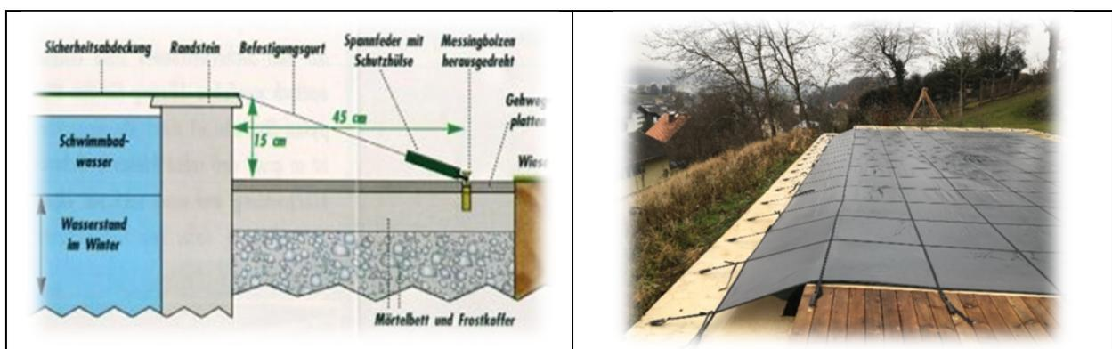
Für Schwimmbecken, die mehr als 15 cm aus dem Boden ragen, wird der Messingbolzen mit einem Abstand von mindestens 45 cm von der Beckenkante am Gehweg oder in der Wiese montiert.
