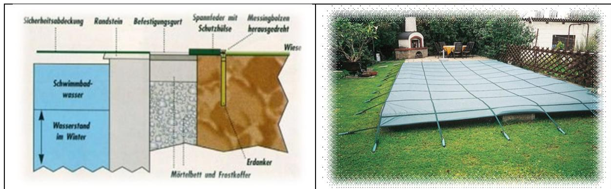
*Für Schwimmbecken ohne umlaufenden Gehweg, werden spezielle Erdankern aus Edelstahl zur Befestigung angeboten, damit wird das Sicherheitsnetz in der Wiese befestigt. Im Sommer werden die Befestigungsbolzen im Boden plan versenkt, so dass ohne Probleme der Rasen gemäht werden kann und keine Verletzungsgefahr gegeben ist.*
