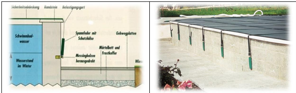
Für Schwimmbecken, die mehr als 40 cm aus dem Boden herausragen oder an einer Hanglage gebaut wurden, kann das Sicherheitsnetz auch lotrecht montiert werden.
