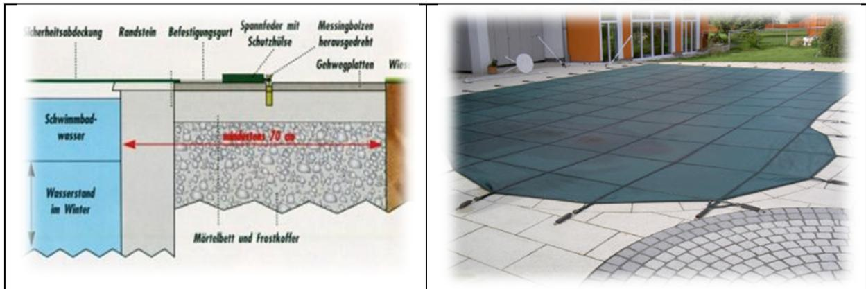
Die Schwimmbeckenabdeckung wird mittels Messingbolzen und Spannfedern befestigt. Die Bolzen können mit jeder Bohrmaschine eingebohrt werden. Im Sommer sind die Bolzen plan im Boden versenkt.
